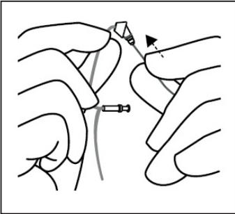
2. A continuación, introduzca el cable de limpieza por la parte superior del tubo fino, donde se conecta al audífono. Pase el cable de limpieza completamente para eliminar todos los residuos.
