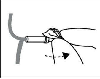
4. Compruebe que el domo está bien sujeto levantando con cuidado la parte inferior del mismo y comprobando que el collarín cubre completamente el extremo estriado del tubo fino.
