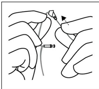
2. 接下来，将清洁线从导声管与助听器连接处的顶端插入。将清洁线从导声管中完全穿过，以便彻底清除碎屑。
