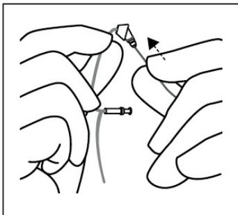
5. 最后, 将导声管重新插入助听器并确保其连接到位。
