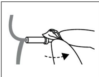
4. 轻轻掀起受话器下部, 检查受话器是否已安装妥当 (即套环完全包覆导声管棱形端)。
